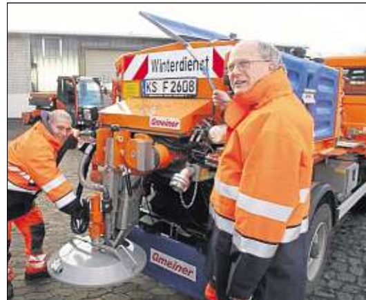
Salz und Sole: Beides kann mit dem Kompaktfahrzeug verstreut werden. Über den Einsatz und das Mischverhältnis entscheiden die Fahrer Marc Meyer (links) und Thomas Lippold während der Fahrt.
